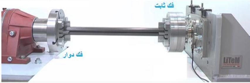
الشكل (9) مخطط لآلة اختبار على التعب بفعل الفتل [8]
