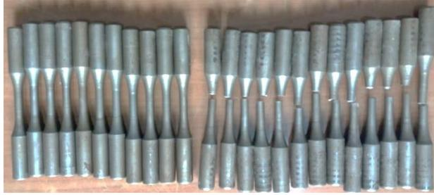
الشكل (44) صورة لبعض عينات الاختبار قبل وبعد الاختبار
